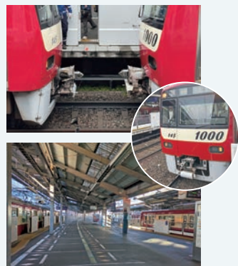
金沢文庫駅での 連結作業の様子
