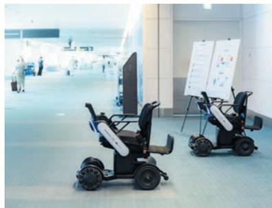
着したのちに、手元のタッチパネルで目的ゲートを選択するだけ。ゲートまで自動運転で走行し、降車後はステーション(駐車場所)まで無人で戻るため、介助や人手を必要としない。空港における人搬送用途での自動運転パーソナルモビリティの実用化はWHILLが世界初だという。
