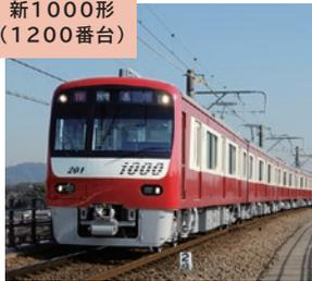
2007年に京急電鉄初のステンレス車体を採用して登場した車両です。車体にはカラーフィルムで京急の赤い電車のイメージを表現し、先頭部は普通鋼に赤色の塗装をして従来のスタイルを残しています。車内は車端部をロングシートに変更し、側窓を一部開閉可能としました。引き続き、バリアフリー対応をするとともに、乗務員室の背面に非常脱出ハンゴを設置。乗務員室は運転台を高くするなど乗務員の安全性と居住性を向上しました。また、主要機器は国産品を採用し、2012年度新造車からLED照明を採用しています。2015年度新造車1800番台から車体側面に幅広の赤と白色フィルムを採用しています。2017年度新造車1200番台から全面塗装を採用しています。<4両編成14本(56両)、6両編成24本(144両)、8両編成18本(144両)>
