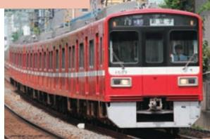
京急電鉄で初めて交流モーターを用いたVVVF制御方式を採用した、省エネルギー、省メンテナンス車両で1990年に登場しました。ブレーキを極力電力回生ブレーキとして一層の省エネルギーを図った新しいブレーキ方式を採用しました。2006年から更新工事を行い、リニューアルを図りました。また、界磁チョップ車からの改造車両も加わり、さらなる省エネルギー化を図っています。<6両編成15本(90両)、8両編成5本(40両)>
