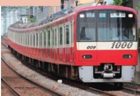
2002年に登場した都営浅草線、京成線、北総線への乗り入れを考慮した車両です。車内は扉間がバケットタイプのロングシートで、車端部は補助イス付きのクロスシートとなっています。また、2100形と同様に海外製品を採用し、車両性能と居住性の向上を図りつつ、コスト低減も実現しました。さらに、全出入口扉にドア開閉チャイムの設置や冷房装置にオゾン層破壊係数ゼロの近代替冷媒の新規採用など、バリアフリーや環境対策にも貢献しています。2017年度から更新工事を行い、VVVF装置、主電動機の国産化やLED照明を採用するなどのリニューアルを図っています。<4両編成12本(48両)、8両編成9本(72両)>
