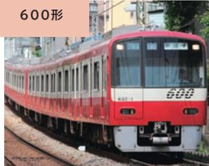
1994年に登場した都営浅草線、京成線、北総線への乗り入れを考慮した車両です。足回りは省エネルギー、省メンテナンスを図ったVVVF制御方式を採用しています。製造当初は、画期的な3扉オールクロスシートを採用しましたが、2005年からは現在の二ーズにあわせ、ドア間の座席をロングシートに改造する工事が実施され、2009年からは更新工事を行い、リニューアルを図りました。<4両編成6本(24両)、8両編成8本(64両)>
