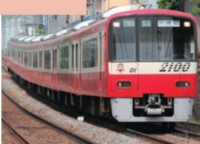
1998年に2000形の後継車として登場した2扉オールクロスシート車両です。扉間のクロスシートは京急では初めての転換シートです。全出入口扉上部には車内案内表示器を採用し、連結間外観を採用するなど、バリアフリー対策にも配慮しており、主にウィング号、快特に使用しています。VVVF装置、主電動機は海外製品を採用していましたが、機器更新の際に国産品に置換えています。2013年度から更新工事を行い、LED照明を採用するなどのリニューアルを図りました。<8両編成10本(80両)>
