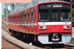
第2世代の都営浅草線、京成線、北総線への乗り入れ車両として、界磁チョップ制御を採用し、1985年に登場しました。1988年からはアルミ合金製車体を採用し軽量化を図りました。2001年から更新工事を行い、リニューアルと同時にバリアフリー化工事も行っています。<4両編成7本(28両)>
