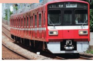
第2世代の都営浅草線、京成線、北総線への乗り入れ車両として、界磁チョッパ制御を採用し、1985年に登場しました。1988年からはアルミ合金製車体を採用し軽量化を図りました。2001年から更新工事を行い、リニューアルと同時にバリアフリー化工事も行っています。<4両編成7本(28両)>
