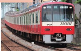
2002年に登場した都営浅草線、京成線、北総線への乗り入れを考慮した車両です。車内は扉間がバケットタイプのロングシートで、車端部は補助イス付きのクロスシートとなっています。また、2100形と同様に海外製品を採用し、車両性能と居住性の向上を図りつつ、コスト低減も実現しました。さらに、全出入口扉にドア開閉チャイムの設置や冷房装置にオゾン層破壊係数ゼロの近代替冷媒の新規採用など、バリアフリーや環境対策にも貢献しています。<4両編成12本(48両)、8両編成9本(72両)>
