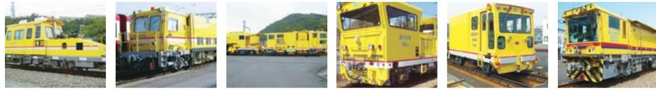
軌道検測車「EM30」、マルチプルタイタンパー「08-16U」、パラストフィニッシャー「802B号車」、モーターカー「105D号車」、遠隔制御車「RC701C号車」、レール削正車「RG301」
