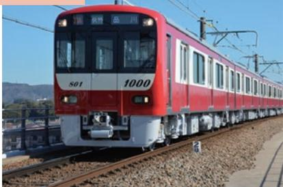
2007年に京急電鉄初のステンレス車体を採用して登場した車両です。車体にはカラーフィルムで京急の赤い電車のイメージを表現し、先頭部は普通鋼に赤色の塗装をして従来のスタイルを残しています。車内は車端部をロングシートに変更し、側窓を一部開閉可能としました。引き続き、バリアフリー対応をすとも、乗務員室の背面に非常脱出ハシゴを設置。乗務員室は運転台を高くするなど乗務員の安全性と居住性を向上しました。また、主要機器は国産品を採用し、2012年度新造車からLED照明を採用しています。2015年度新造車1800番台から車体側面に幅広の赤と白色フィルムを採用しています。<4両編成13本(52両)、6両編成12本(72両)、8両編成13本(104両)>
