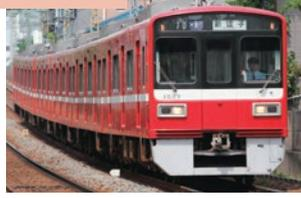
京急電鉄で初めて交流モーターを用いたVVVF制御方式を採用した、省エネルギー、省メンテナンス車両で1990年に登場しました。ブレーキを極力電力回生ブレーキとして一層の省エネルギーを図った新しいブレーキ方式を採用しました。2006年から更新工事を行い、リニューアルを図りました。また、界磁チョッパ車からの改造車両も加わり、さらなる省エネルギー化を図っています。<6両編成15本(90両)、8両編成5本(40両)>
