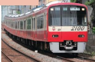
1998年に2000形の後継車として登場した2扉オールクロスシート車両です。扉間のクロスシートは京急では初めての転換シートです。全出入口扉上部には車内案内表示器を採用し、連結間外観を採用するなど、バリアフリー対策にも配慮しており、主にウィング号、快特に使用しています。VVVF装置、主電動機は海外製品を採用していましたが、機器更新の際に国産品に置換えています。2013年度より更新工事を行い、LED照明を採用するなどのリニューアルを図っています。<8両編成10本(80両)>
