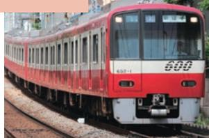
1994年に登場した都営浅草線、京成線、北総線への乗り入れを考慮した車両です。足回りは省エネルギー、省メンテナンスを図ったVVVF制御方式を採用しています。製造当初は、画期的な3扉オールクロスシートを採用しましたが、2005年からは現在の二ーズにあわせ、ドア間の座席をロングシートに改造する工事が実施され、2009年からは更新工事を行い、リニューアルを図りました。<4両編成6本(24両)、8両編成8本(64両)>
