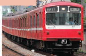
1978年に3両固定編成で登場した4扉車です。京急電鉄初の右手ワンハンドルマスコンやFRP(ガラス繊維強化プラスチック)を多用した室内など、以後の鉄道車両に多大な影響を与えました。また、界磁チョッパ制御、電力回生ブレーキなど省エネルギー車両の先駆けとなり、1979年にローレル賞を受賞しています。現在では、すべて2両固定編成化され、主に普通運用に使用しています。<6両編成12本(72両)>
