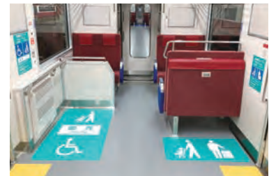
▲車体更新後の車内（多目的スペースのステッカー・フロアシット貼付）
