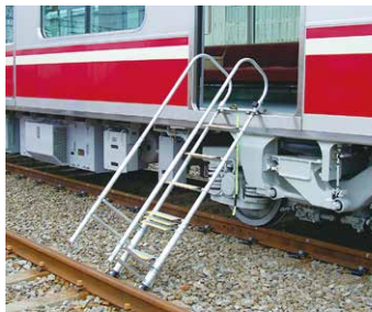
▲ 非常脱出ハシゴを設置した様子
