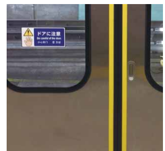
▲ドア注意ステッカー・ ドア内側戸先の黄色表示
