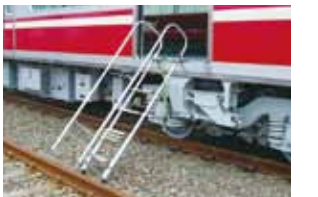
非常脱出ハシゴを設置した様子
