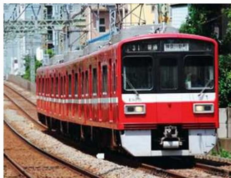
界磁チョッパ制御車・鋼製車の例 (1500形)
