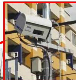
従来より検知領域が拡大した 三次元レーザレーダ方式 の障害物検知装置
