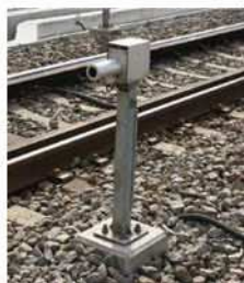
従来型の障害物検知装置
