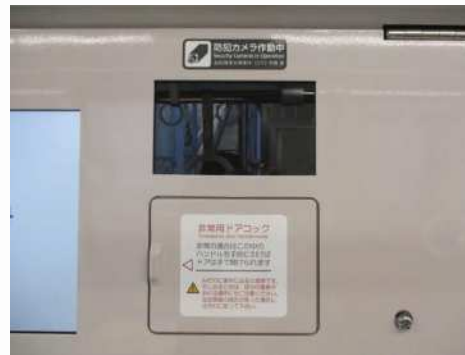
車内監視カメラ設置例 (将来的に全車両に設置)
