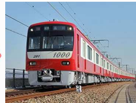
VVVF制御車・ステンレス車の例 (新1000形)
