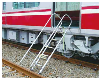
▲非常脱出ハシゴを設置した様子
