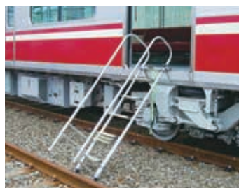
▲非常脱出ハシゴを設置した様子
