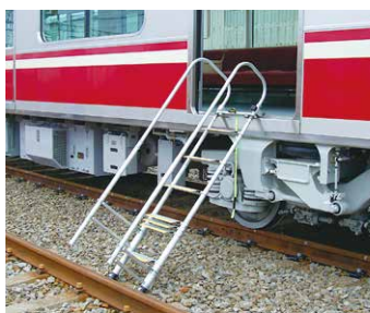
▲ 非常脱出ハシゴを設置した様子
