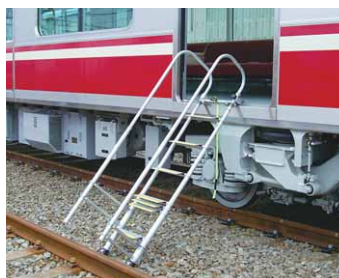
▲非常脱出ハシゴを設置した様子
